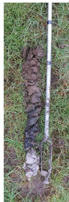
*Carottage à 70 cm de profondeur sur prairie humide sur PAEC SNAV. Horizon réductique à partir de 50 cm*
