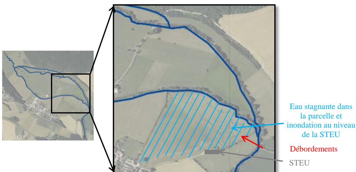
**Figure 57:** Analyses terrain au niveau de l'ouvrage Ancien Fourneau
