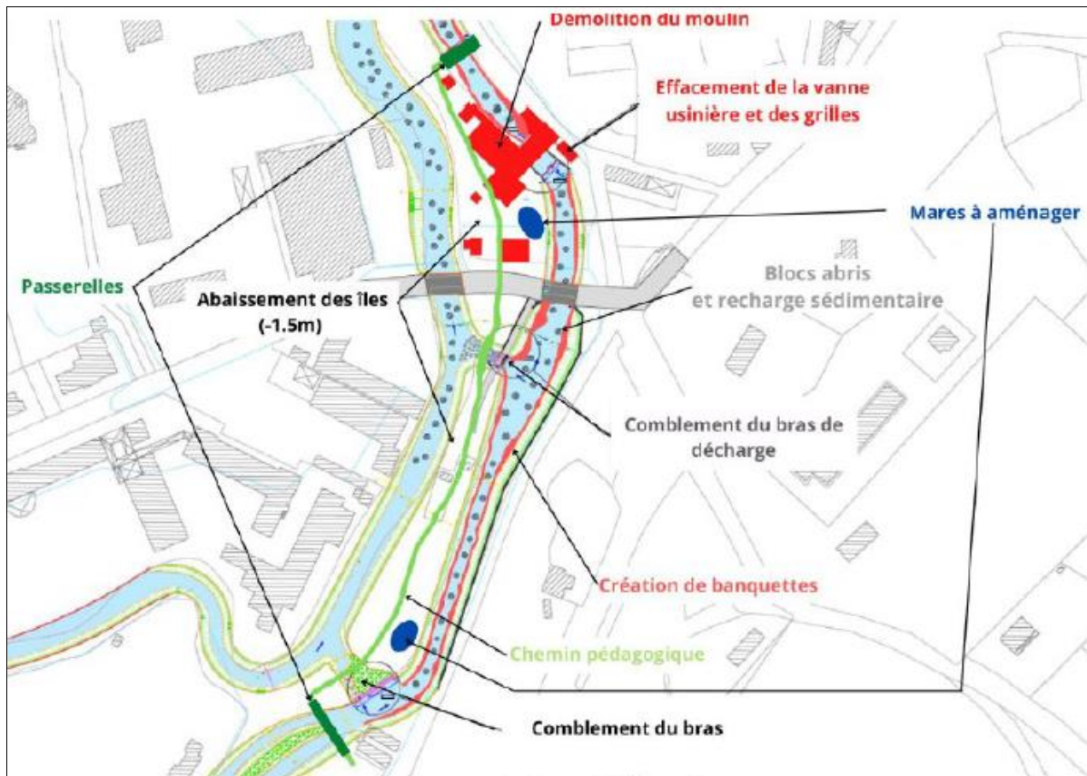
Figure 3 : Projet d'aménagement du secteur du moulin Lemoine. Source : EPAGE Sequana, 2022
